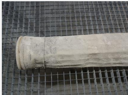
HORNÍ ČÁST FB (funkční - vnější strana)
