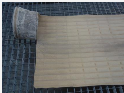
HORNÍ ČÁST FB (čistá - vnitřní strana)
